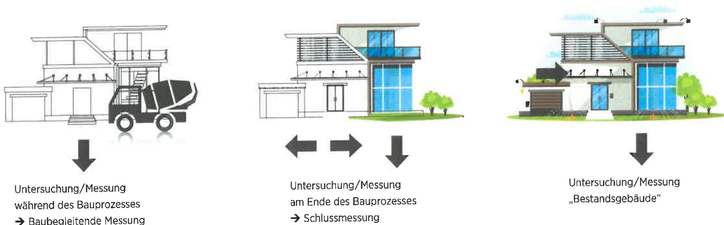
Abbildung 1: Typen der Luftdichtheitsmessung – Differenzierung nach der Lebensphase des Objektes
