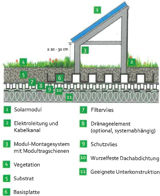
1 Schematischer Schnitt durch ein auflastgehaltenes Solar-Gründach: Der Gründachaufbau hält die PV-Aufständerung lagesicher und ohne Dachdurchdringung.
